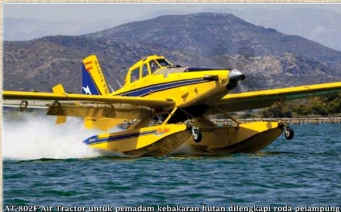
AT-802F Air Tractor untuk pemadam kebakaran hutan dilengkapi roda pelampung
